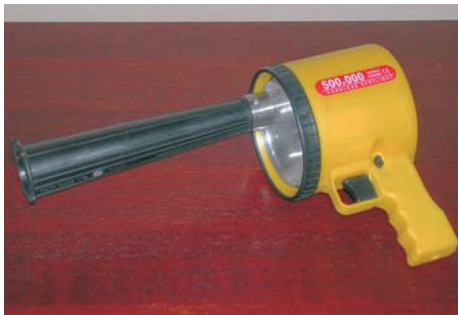
Рис. 2. Ультразвуковой уровнемер «УЗИ-АГРО»
