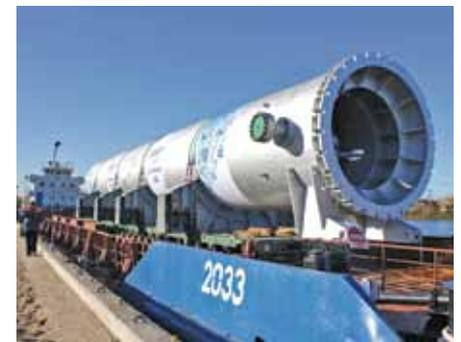
**Реактор десинтегратора гидравлического примерно 1400 тонн для Refinería de Petróleo de Tuapsé.**
