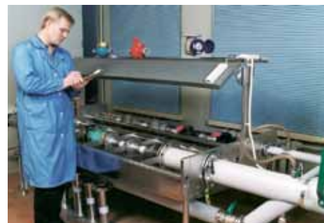
Проверка счетчиков холодной воды на проливной расходомерной установке «ASITROM» STEP-100
